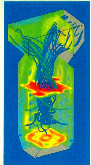
Поле температур и траектории угольных частиц в топке котла П-67.
